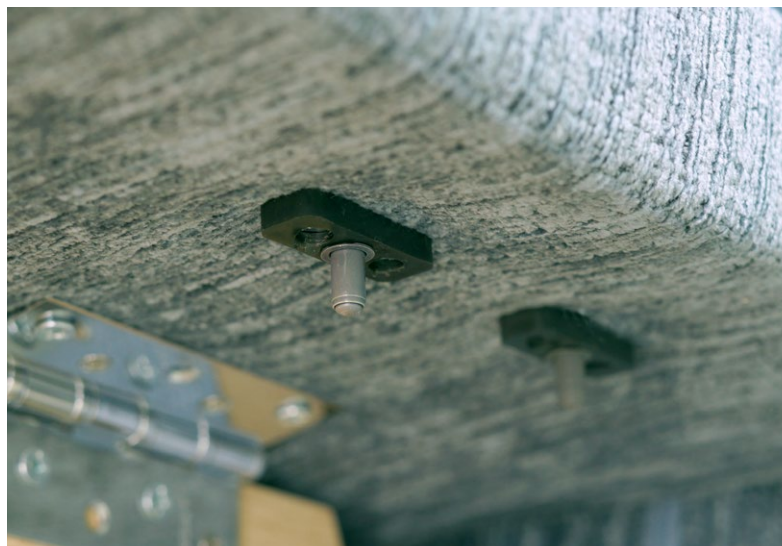
Доводчики Blum расположенные в нижней части спинки
