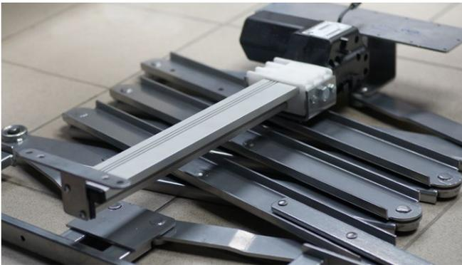
■ высокотехнологичный прецизионный электропривод и пантограф механизма
